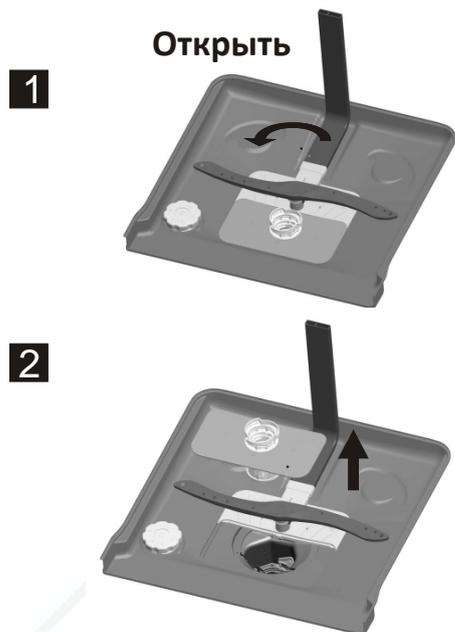
1. Поверните фильтр против часовой стрелки.
