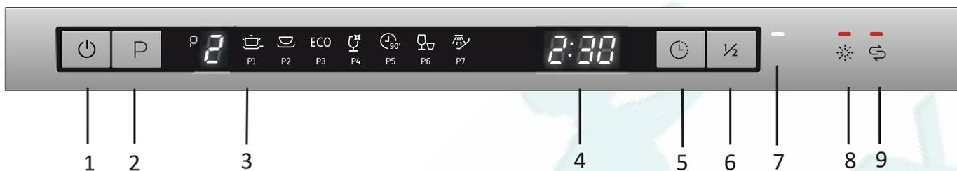
1. Кнопка Вкл./Выкл.: для включения/выключения питания.
